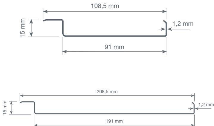
El sistema cuenta con perfiles de acabado para remate y unión de lamas que permiten la instalación del techo en cualquier espacio o superficie tanto en zonas de interior como exteriores. Se recomienda una distancia máxima entre soportes metálicos de 80 cm.
