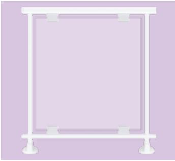
Diseño de barandal acristalado, colocando y asegurando éste mediante pinzas de sujeción de aluminio.
